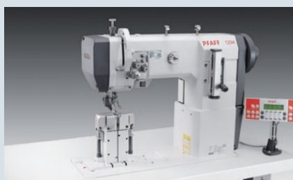
PFAFF 1293/1294 - Ein- und Zweinadel-Säulenmaschine mit Radtransport für den Einsatz im schweren Anwendungsbereich
