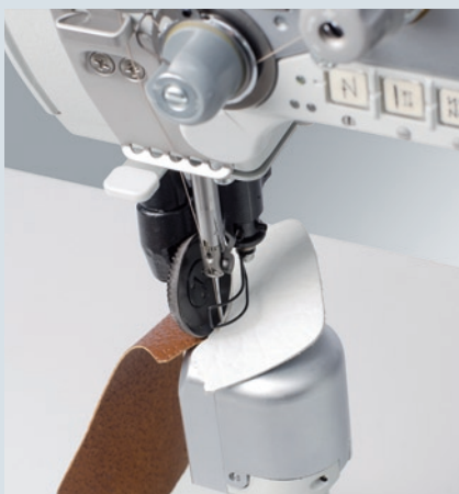
Montagenähte beim Kinderschuh Assembly seams on a children shoe
