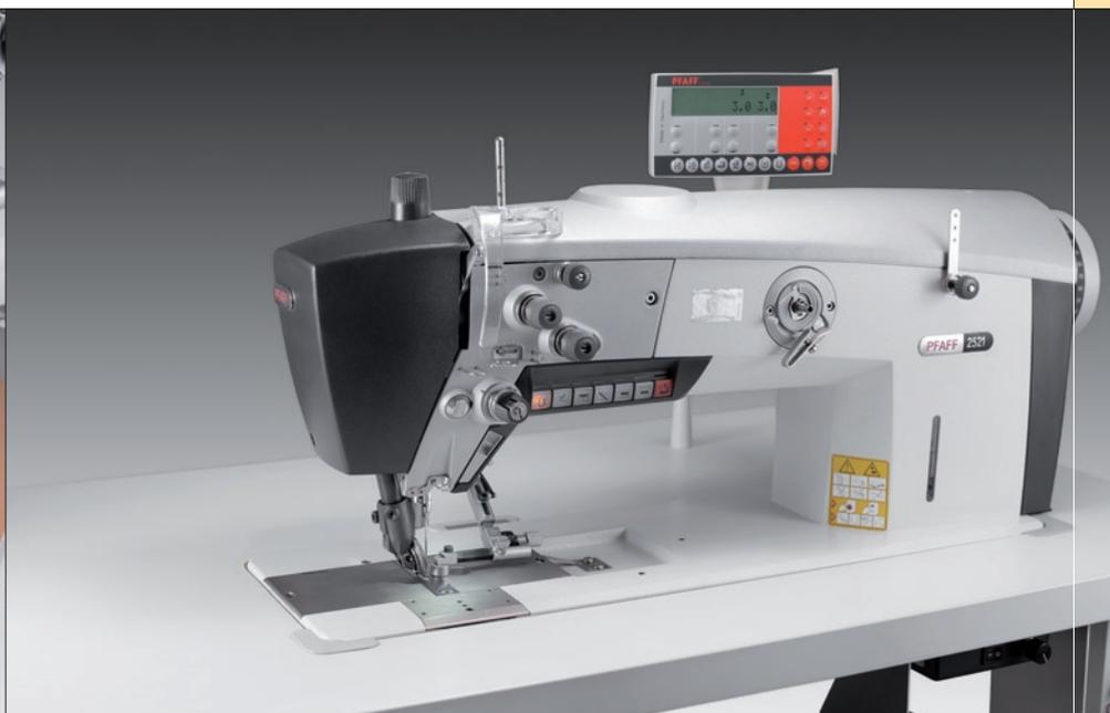
Специальная швейная машина с игольным транспортом, нижним и верхним роликовыми транспортерами с приводом от раздельных шаговых двигателей
