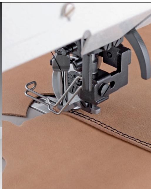
Двухигольная швейная машина с плоской платформой, с увеличенными вертикальными челноками, приводной роликовой лапкой и нижним транспортом
