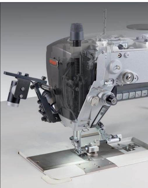
Интегрированное рабочее место для выполнения документированного шва, который должен разорваться при срабатывании подушки безопасности
