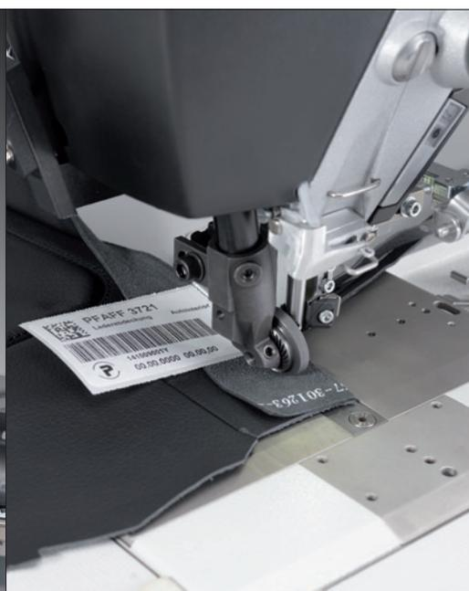
Система документированного шва (швейная головка с игольным транспортом и дифференциальными нижними и верхними роликовыми транспортерами)
