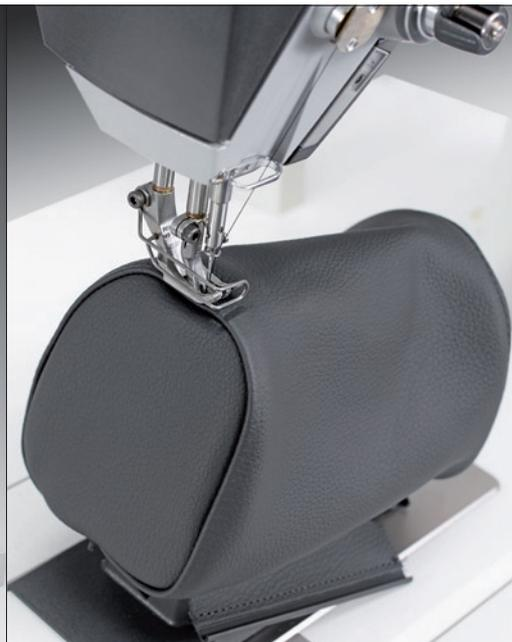
Одноигловая колонковая машина челночного стежка с нижним, шагающим верхним и игольным транспортом
