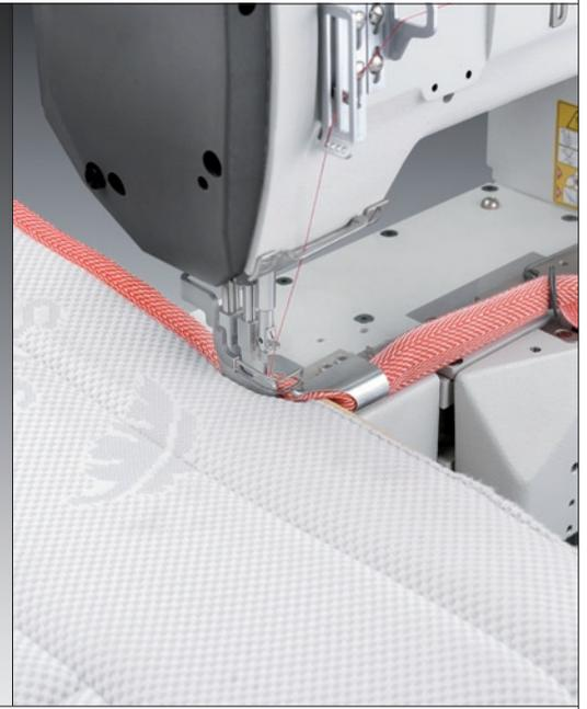
Специальная швейная головка двухниточного цепного стежка с нижним, верхним и игольным транспортом
