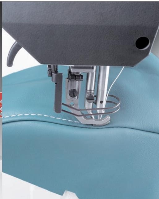
Одноигловая колонковая машина с челночного стежка с нижним, шагающим верхним и игольным транспортом
