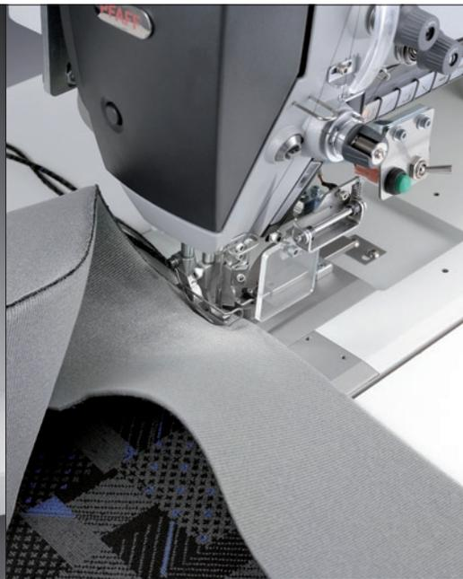
Специальная швейная машина с нижним, шагающим верхним и игольным транспортом, вертикальным челноком и устройством обрезки края
