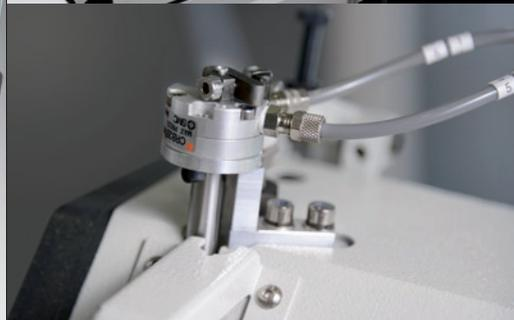
Швейная установка с числовым программным управлением, с устройством смены зажимов, для работы с перекрытием по времени
