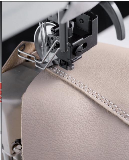
Двухигольные колонковые швейные машины челночного стежка с увеличенным вертикальным челноком, нижним транспортом и приводной роликовой лапкой
