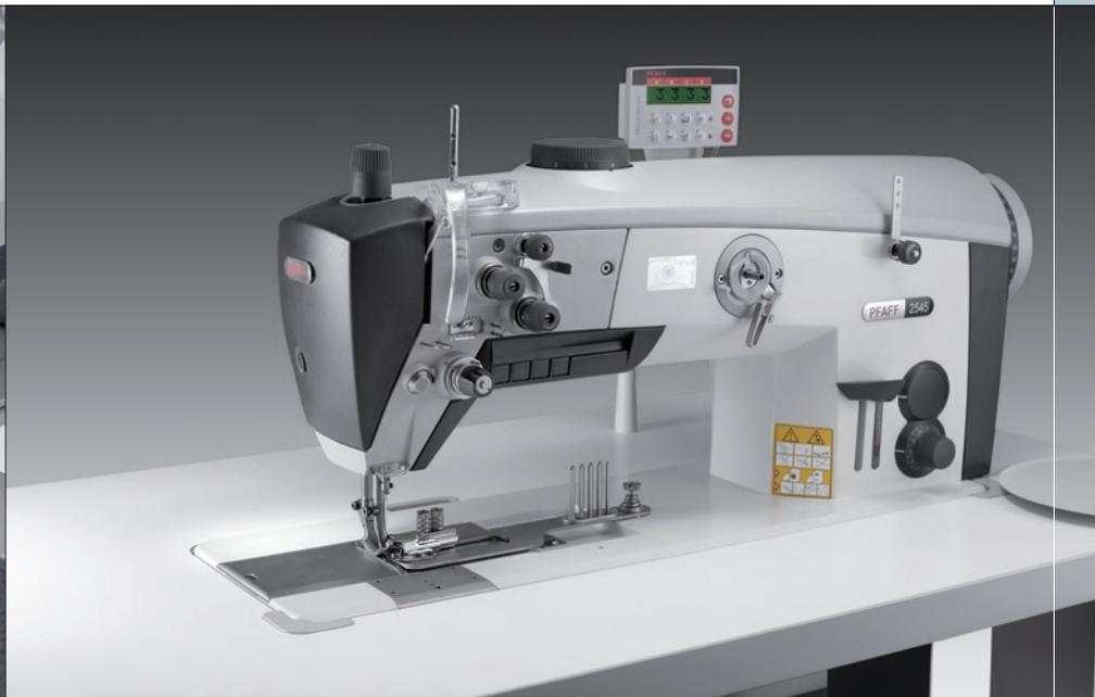
Специальная швейная машина с нижним, шагающим верхним и игольным транспортом, вертикальным челноком и подвижным окантовывателем
