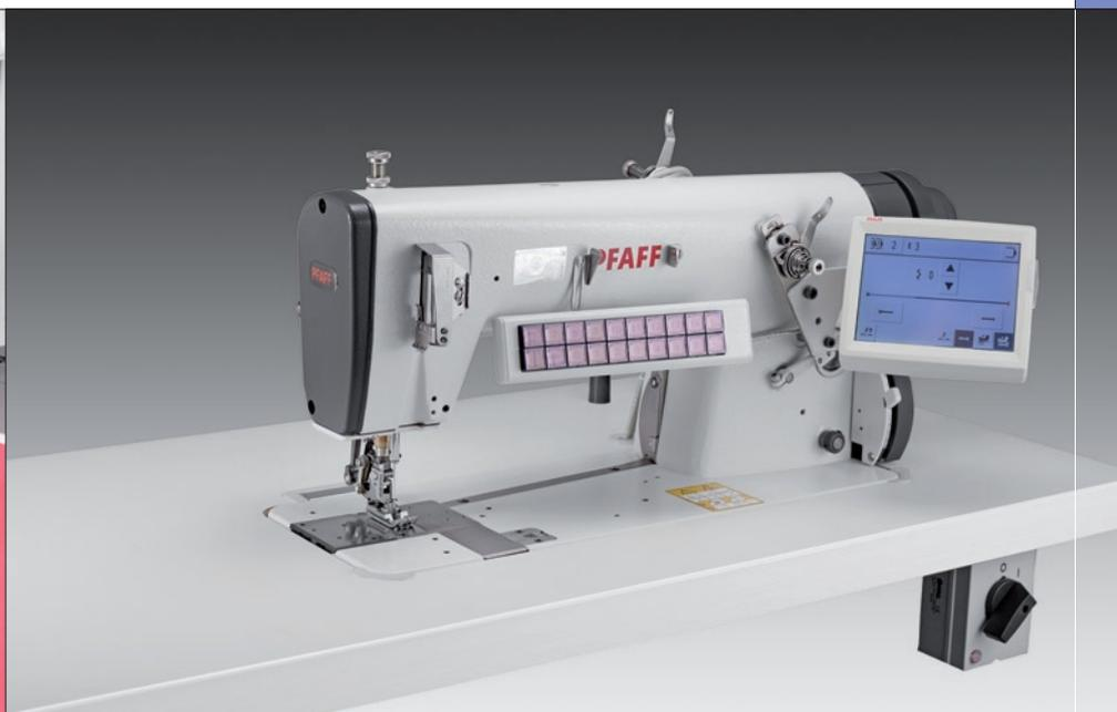
Высокоскоростная швейная машина двухниточного цепного стежка с нижним и дифференциальным верхним транспортом
